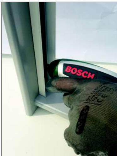
Fissare il profilo portamagnete con le viti
